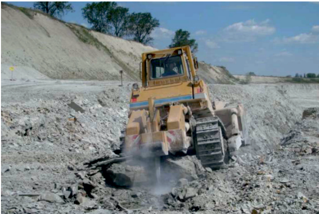
Rys. 6. Urabianie skał wapiennych spycharką ze zrywakiem Fig. 6. Mining of limestone rocks by crawler with ripper
