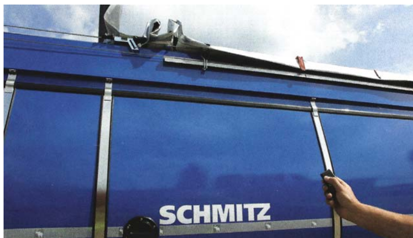
Rys. 1. Skrzynia ładunkowa z termoizolacją o objętości 18 m 3 ; pojazd przeznaczony do transportu mieszanki mineralno-asfaltowej
