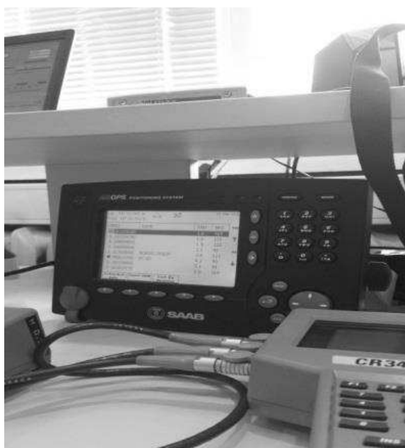
Rys. 1. Stanowisko rejestracji sygnałów wraz z urządzeniem odbiorczym AIS SAAB R4 Fig. 1. Station for recording signals along with AIS SAAB R4 receiver
