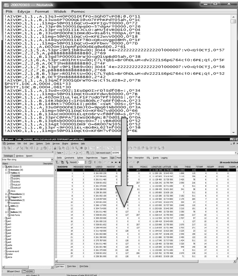
Rys. 2. Obsługa zapisanych danych AIS z wykorzystaniem oprogramowania IBSExpert typu Client do zarządzania bazą danych
