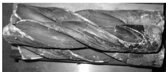
Rys. 14. Wiertła ze stali narzędziowej do pracy na zimno (100Cr6) wykonane w procesie wyciskania
