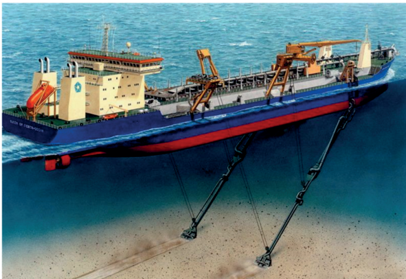
Rys. 2. Schemat poboru próbek przez płaskodenną pogłębiarkę ssącą (Van Oord HAM – 318) (Źródło: Van Oord)
