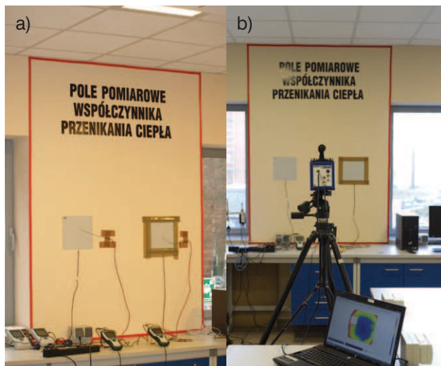
Rys. 3a, 3b. Stanowisko pomiarowe współczynnika przenikania ciepła. Budynek Uniwersytetu Warmińsko-Mazurskiego w Olsztynie (fot. autor)
