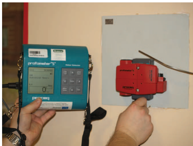
Rys. 4. Badanie mające na celu wykluczenie wpływu kotew stalowych w ścianie trójwarstwowej na odczyt z płytowego czujnika mierzącego gęstość strumienia ciepła (fot. autor)
