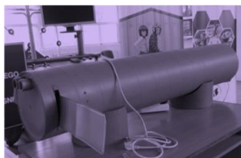
urządzenie pokazujące rozchodzenia się światła przez materiały odbłaskowe (tzw. „tuba dr Targosińskiego”)
