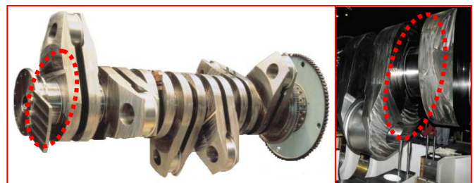
Rys. 4. Widoczne ślady zużycia korozyjnego wynikłego z przegrzania łożyska [10]
