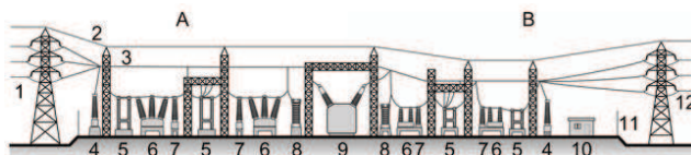
Rys. 1. Elementy stacji elektroenergetycznej [9]
