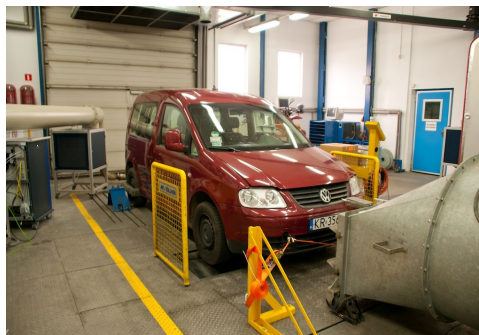
Rys. 5. Hamownia podwoziowa ITS badany samochód osobowy VW Caddy 2,0 dm 3 (Euro 4)
