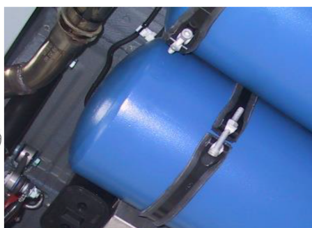
Rys. 6. Schemat lokowania stalowych, ciśnieniowych butli do przechowywania CNG w samochodzie VW Caddy [8]
