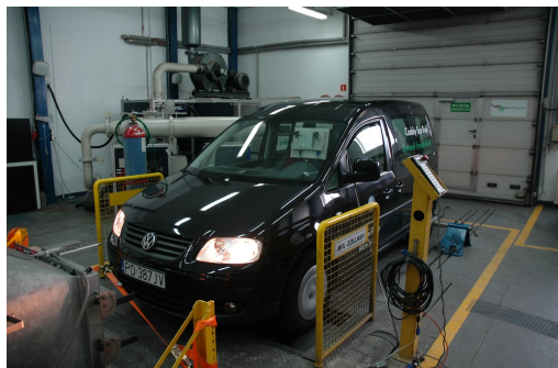
Rys. 4. Hamownia podwoziowa ITS badany samochód osobowy VW Caddy 1,4 dm 3 (Euro 4)
