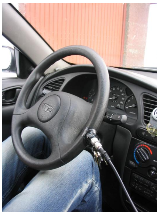
Rys. 9. Sposób i miejsce pomiaru drgań działających na kierowcę, (a) kierunek Z, (b) kierunek X
