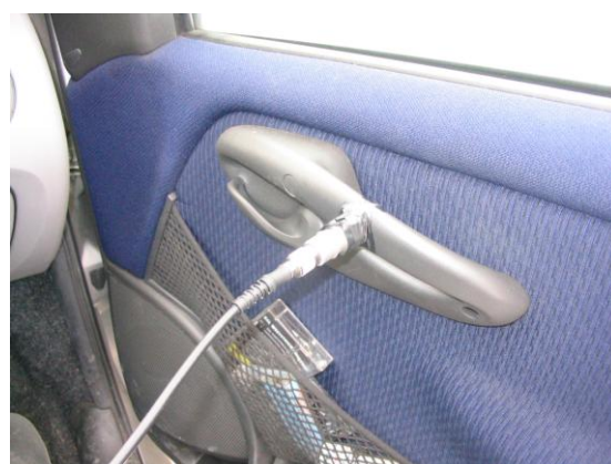
Rys. 7. Sposób i miejsce pomiaru drgań działających na pasażera, (a) kierunek Z, (b) kierunek X
