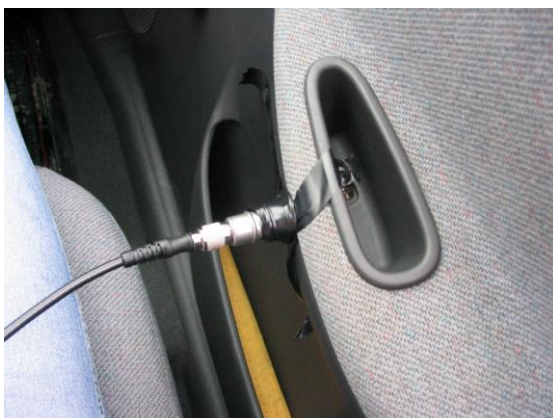
Rys. 8. Sposób i miejsce pomiaru drgań działających na pasażera, (a) kierunek Z, (b) kierunek X
