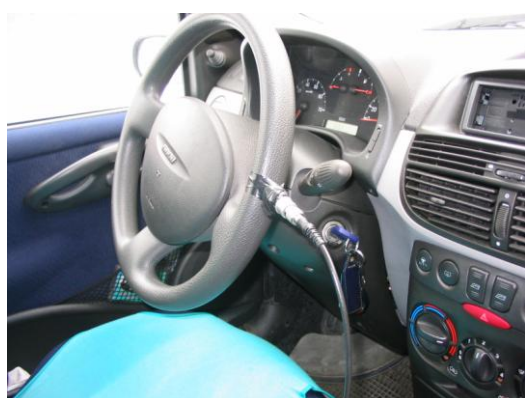
Rys. 6. Sposób i miejsce pomiaru drgań działających na kierowcę, (a) kierunek Z, (b) kierunek X
