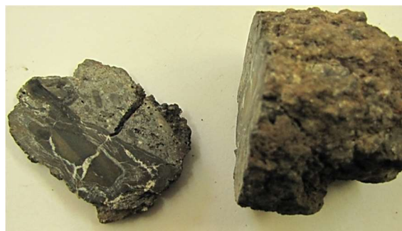
Rys. 15.5 Próbkę nr 4, widoczne białe żyłki węglanu wapnia wypełniające spękania
