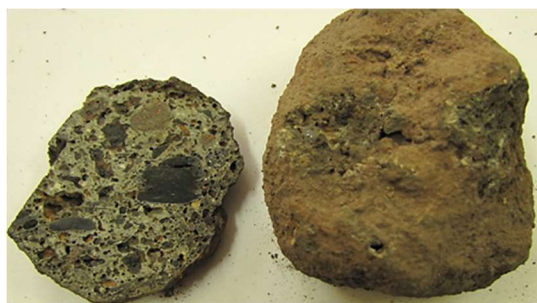
Rys. 15.2 Próbkę nr 1, widoczne dwie strefy różniące się barwą i cechami petrograficznymi
