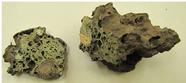
Rys. 15.6 Próbka nr 5, widoczne liczne pory w szarozielonej masie
