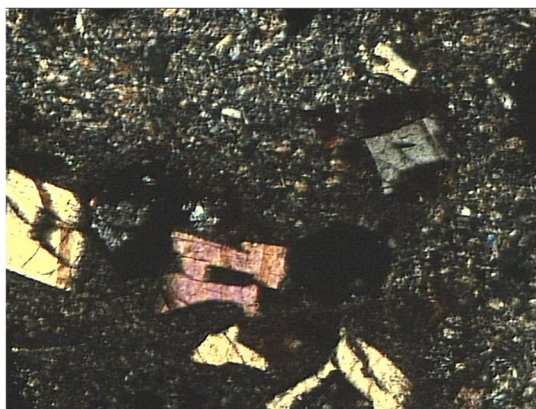
Rys. 15.10 Prakryształy piroksenów. Próbka 2, pow. 100x, nikole skrzyżowane
