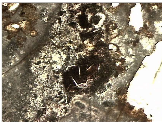
Rys. 15.7 Z prawej obtopione ziarno kwarcu, w centrum ciemnobrunatne szkliwo z igielkami mullitu. Próbka 1z, pow. 100x, nikole równoległe
