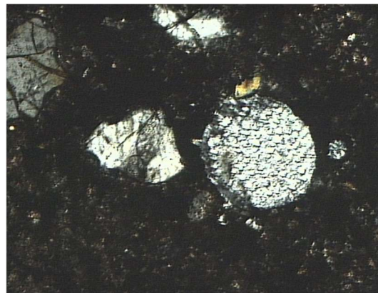
Rys. 15.8 Okrągła pora wypełniona gipsem, z lewej i u góry spękana ziarna kwarcu. Próbka 1z, pow. 100x, nikole skrzyżowane
