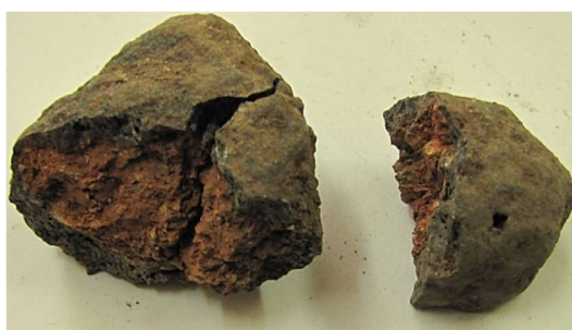
Rys. 15.3 Próbkę nr 2, widoczne pozostałości węgla oraz pory
