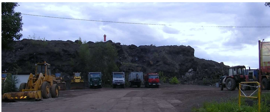
Rys. 15.1 Zwałowisko odpadów po hutnictwie Zn-Pb, z których produkowane jest kruszywo
