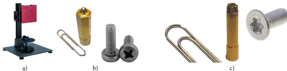
Rys. 9. a) Stanowisko pomiarowe dla analizy „małych” elementów – narzędzi kuźniczych wraz ze skanerem Atos Core oraz przykładowe precyzyjne stempelki kuźnicze i śruby z odkutym kształtem łbów: b) krzyżakowym i c) typu TORX
