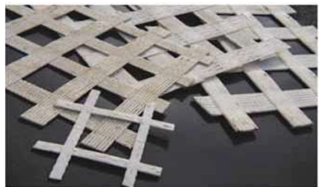
Rys. 11. Przykłady siatek typu PGG o różnych wymiarach oczka Fig. 11. Examples of meshes type PGG with different grid sizes
