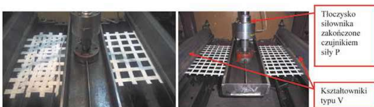
Rys. 8. Sposób montażu siatek na elementach obudowy w stanowisku badawczym: a – siatka typu PGG; siatka typu SGG
