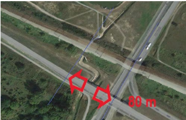
Rys. 3. Widok usytuowania otworu geotechnicznego nr 2 (w osi wiaduktu drogowego), wykonywanego w ramach dokumentacji geotechnicznej na potrzeby budowy obwodnicy
