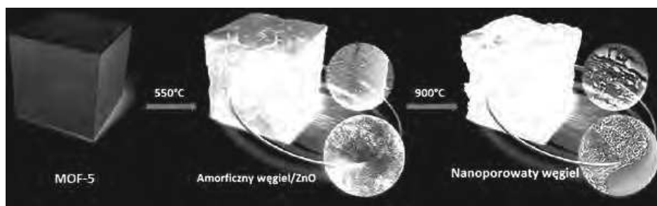
Rysunek 2. Schemat otrzymywania nanoporowatego węgla w wyniku karbonizacji MOF-5 zawierającego jony Zn [45]. Rysunek wykonany na podstawie [45] za zezwoleniem. Prawa autorskie ® 2012, należą do American Chemical Society
