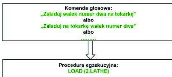
Rys. 2. Przykład przetworzenia komendy głosowej na procedurę egzekucyjną dla robota
