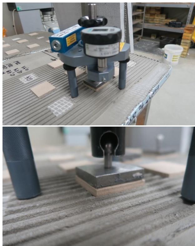
Rys. 1. Stanowisko pomiarowe do badania przyczepności o zakresie pomiaru 1,6-16 kN (fot. J. Karpiesiuk)
