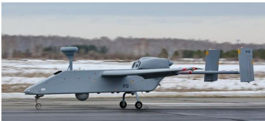
Fot. 2. Rosyjski UAV Forpost powstał przez rozwinięcie kupionej od Izraela licencji na bezzałogowce Searcher Mk II. (MON Federacji Rosyjskiej)
