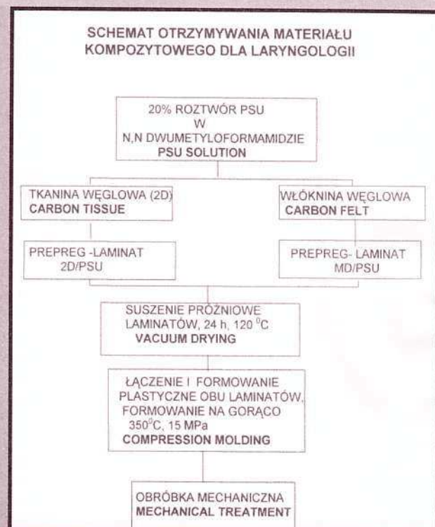
RYS. 2. Sposób otrzymywania materiału kompozytowego.
