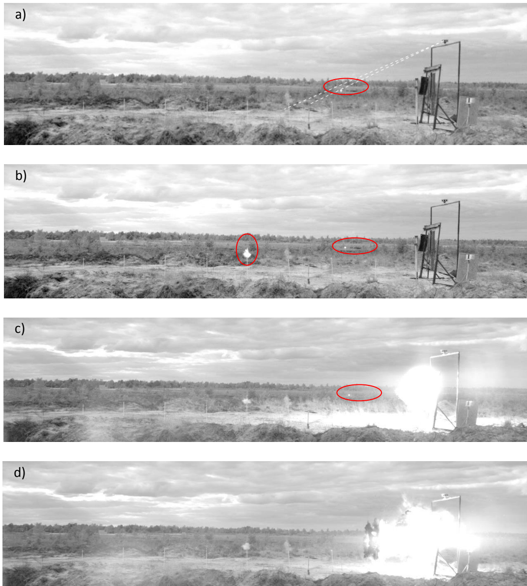
Rys. 13. Kadry z filmu zarejestrowanego dla strzału nr 4 z dnia 01.10.2013 r.: (a) wyjście granatu ze pola widzenia głowicy detekcyjnej, (b) zapłon główki zapalczącej sygnałem z głowicy, c) odpalenie destruktora, (d) zniszczenie granatu przez destruktora
