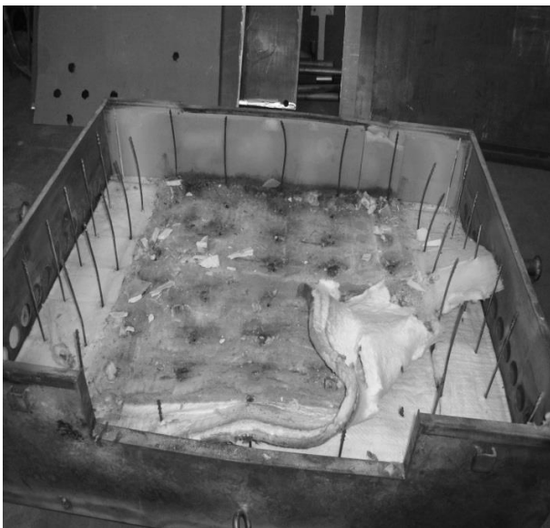
Rys. 8. Izolacja pokrywy mocowana za pomocą szpilek
