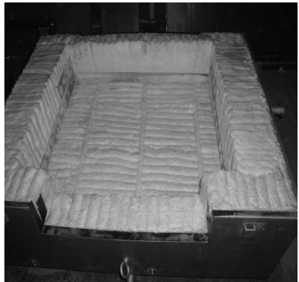
Rys. 9. Pokrywa izolowana modułami włóknistymi
