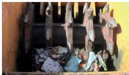
Rys. nr 12 i 13. Rozdrabniacz dwuwalcowy do metalu FX firmy Forrec srl / Widok komory zasypowej pre- rozdrabniacz (pre-shredder) do rozdrabniania złomu metali firmy Morita
