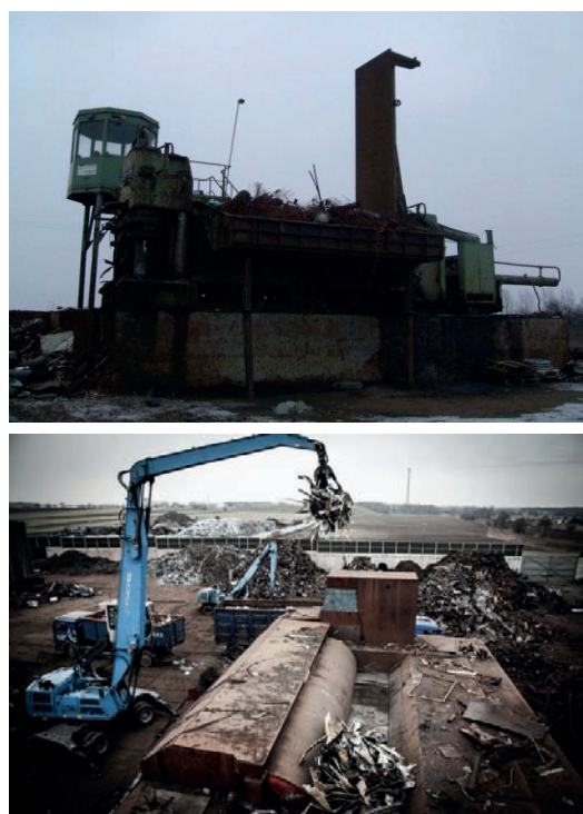
Rys. nr 8 i 9. Prasonożycza stacjonarna firmy Becker (rok produkcji 1980) / firmy Henschel (nacisk na nóż tnący 1000 ton).
