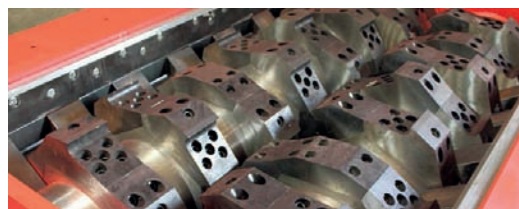
Rys. nr 10 i 11. Rozdrabniacz stacjonarny do metalu TF500 firmy Francoi/r Strzępiarka do puszek stalowych
