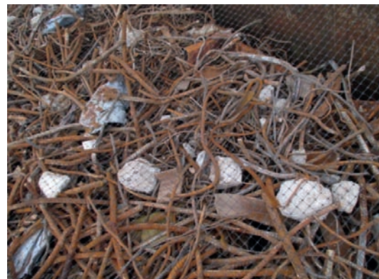
Rys. nr 25 i 26. Przykład typowych zanieczyszczeń w złomie newsadowym do strzępienia: szkło, plastik, tapicerka, tkaniny, guma, beton / złom poamortyzacyjny w postaci prętów i drutów zbrojeniowych z rozbiórki zanieczyszczony betonem.
