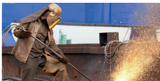
Rys. nr 1 . cięcie termiczne złomu (szyny kolejowe i konstrukcje)
