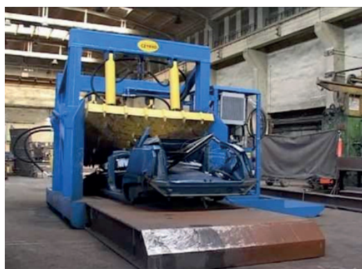
Rys. nr 14 i 15. Paczkarka do złomu Imabe Iberica / urządzenie do zgniotu karoserii samochodowych (po procesie karoseria jest spłaszczona co ułatwia transport i zagęszcza masę nasypową).
