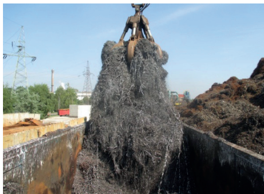
Rys. nr 41 i 42 Przedstawiają wióry stalowe sypkie (wysoka masa nasypowa od 400 do 500 kg/m 3 ) i skłębione (niska masa nasypowa od 100 do 150 kg/m 3 ) oraz trudności z ich rozładunkiem.
