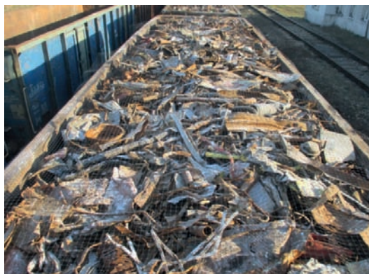
Rys. nr 37 i 38 przedstawiają wagony kolejowe załadowane złomem zagęszczonym i ciężkim (żeliwo) o wysokiej masie nasypowej (przy wypełnieniu procentowym ok. 40 i 60 osiągają masę ok 50 Mg).
