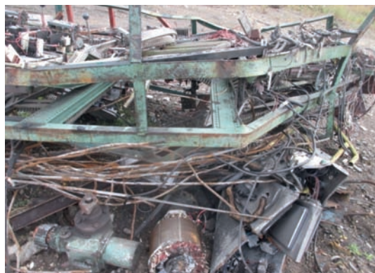
Rys. nr 32. Przedstawia złom pochodzenia elektrycznego (siniki, stojany, przełączniki, uzwojenia, kable itp.) ze względu na dużą zawartość Cu złom ten powinien być poddany dalszemu procesowi separacji.
