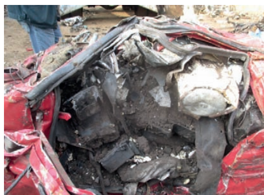
Rys. nr 33 i 34. Przykłady wykorzystania wolnej przestrzeni karoserii samochodu osobowego – utylizacja opon samochodowych, ziemi i tworzyw szt.
