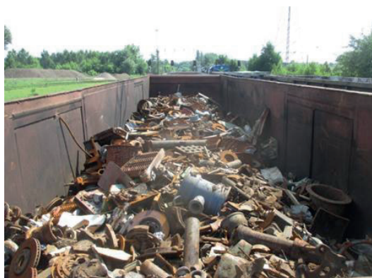
Rys. nr 37 i 38 przedstawiają wagony kolejowe załadowane złomem zagęszczonym i ciężkim (żeliwo) o wysokiej masie nasypowej (przy wypełnieniu procentowym ok. 40 i 60 osiągają masę ok 50 Mg).
