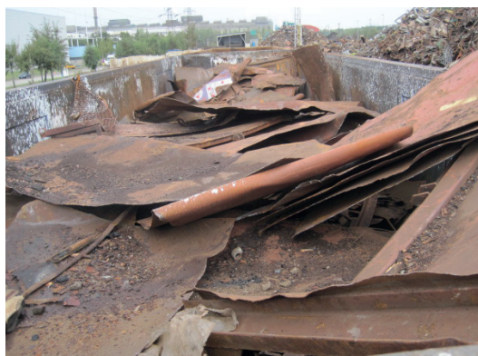
Rys. nr 39 i 40. Złom średni poamortyzacyjny / przestrzeny złom poamortyzacyjny (z poszycia towarowych wagonów kolejowych)
