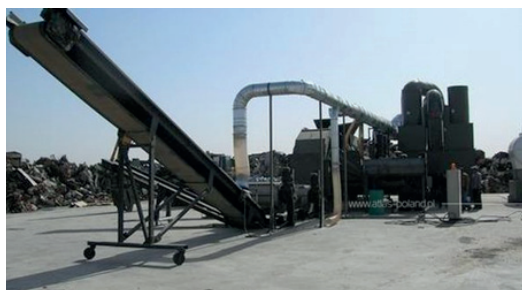
Rys. nr 16 i 17. Strzępiarki mobilna ZB złomu THOR 1915 K (moc silnika 755 KM, waga całkowita 84 tony, napęd spalinowy lub elektryczny)/strzępiarka Bonfiglioli (moc silnika 600-960 KM)
