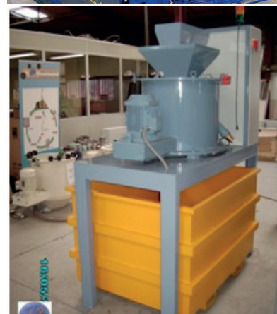
Rys. nr 18 i 19. Brykietarka do wiórów stalowych firmy Bison IV Steel / nr 12 Wirówka SFH 150 do wiórów stalowych SFH.
