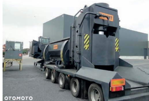
Rys. nr 6 i 7. Półmobilne nożyce kontenerowe CNS 400 firmy Żdas (przystosowane do transportu samochodowego na ciągniku wyposażonym w urządzenie samowyladowawcze) / Mobilne prasonożyce do złomu Lefort 800 T
