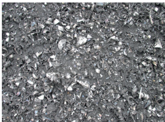
Rys. nr 35 i 36. Przedstawia ciężki złom konstrukcyjny zanieczyszczony betonem i smarem / drobne wióry stalowe przesypane zmieloną zendrą.
