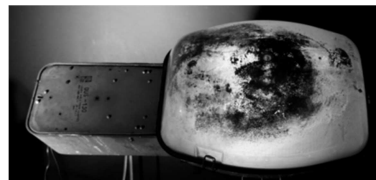
Rys. 2. Świecąca oprawa OUS150 z mocno zabrudzonym kloszem
