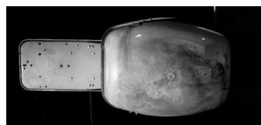
Rys 1. Oprawa OUS150 z mocno zabrudzonym kloszem
