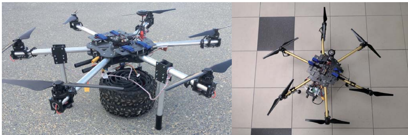
Rys. 4. Platforma testowa (hexacopter) z transportowaną masą (po lewej) i w wersji inspekcyjnej z systemem wizyjnym (po prawej) Fig. 4. Test platform (hexacopter) transported object (on left side) and adjusted for inspection task with vision system (on right)
