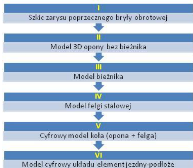
Rys. 2. Etapy modelowania cyfrowego koła napędowego z oponą 14.9R28/8PR
