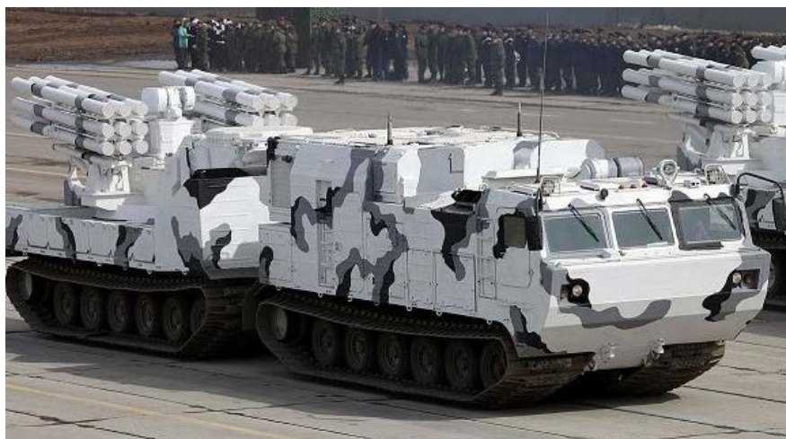
Zdjęcie 2. System rakietowy obrony powietrznej krótkiego zasięgu Pantsir-SA na podwoziu DT-30PM
