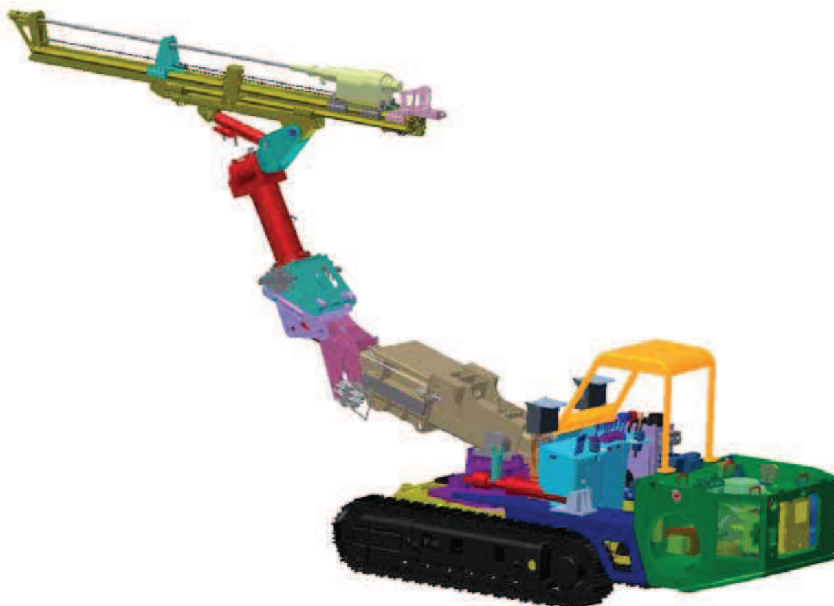
Rys. 1. Model przestrzenny wymiennego osprzętu do wiercenia zabudowanego na ładowarce ŁBT-1200M (opracowanie własne)
