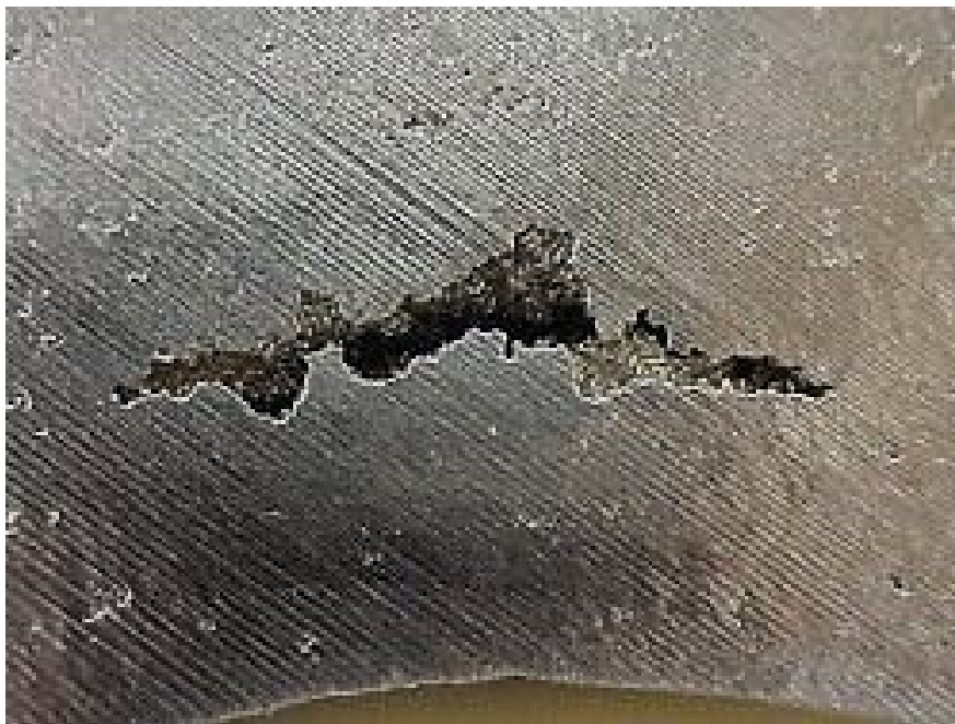
Rysunek 5. Przykład jamy skurczowej ujawnionej w odlewie po głębokiej obróbce mechanicznej [17]
