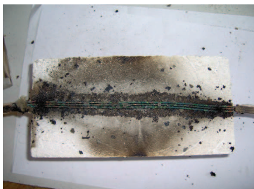
Rys. 1b. Przykład próbki po eksperymencie – zdjęta warstwa tynku
