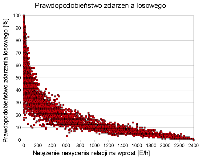
Rys. 5. Prawdopodobieństwa zdarzenia losowego w zależności od natężenia nasycenia dla relacji na wprost
