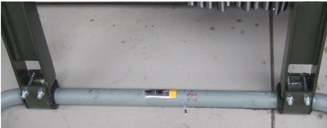
Rys. 5. Stabilizator z naklejonym tensometrem
