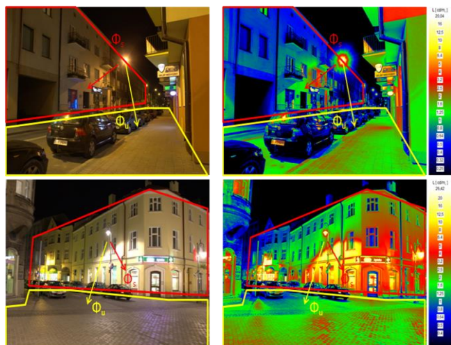
Rys. 6. Ilustracja obrazująca rozdział strumienia świetlnego oprawy na strumień użyteczny \Phi_u i strumień strat \Phi_s , droga z sąsiadującymi zabudowaniami, oprawa w bliskim sąsiedztwie elewacji
