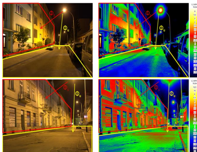
Rys. 7. Ilustracja obrazująca rozdział strumienia świetlnego oprawy na strumień użyteczny \Phi_u i strumień strat \Phi_s , droga z sąsiadującymi zabudowaniami, oprawa oddalona od elewacji
