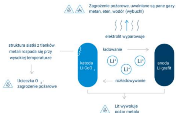
Rys. 11. Mechanizm powstania zapłonu baterii litowo-jonowej (źródło: [22])
