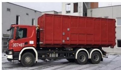
Rys. 16. Pojazd z kontenerem gaśniczym (źródło: [12])
