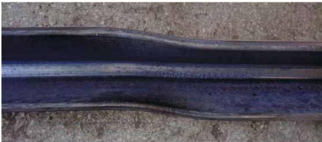
Rys. 5. Widok odkształconej próbki prostego odcinka kształtownika V29 ze stali S480W po statycznej próbie zginania dnem w dół; widoczne charakterystyczne odkształcenie w postaci wybočenja kolnierzy kształtownika
