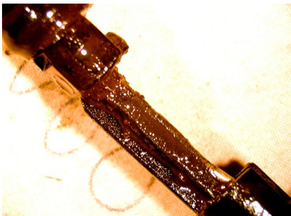
Rys. 3. Osady na elementach wtryskiwacza
