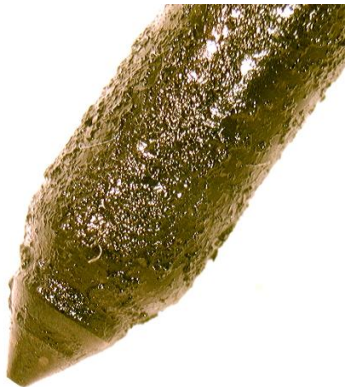
Rys. 1. Iglica wtryskiwacza CR
