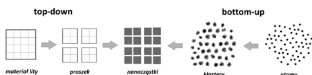
Rys. 1. Schemat syntezy nanocząstek metodami typu „top-down” i „bottom-up”
