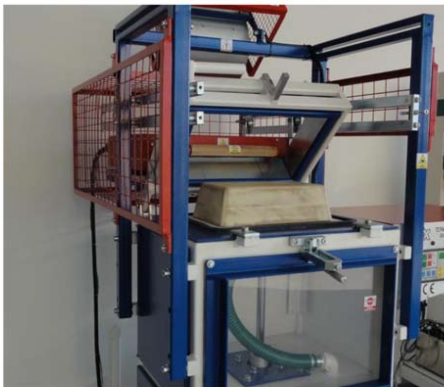
Rys. 3. Wygląd termoformierki PEX B-3 F z formą numer IV w położeniu górnym
