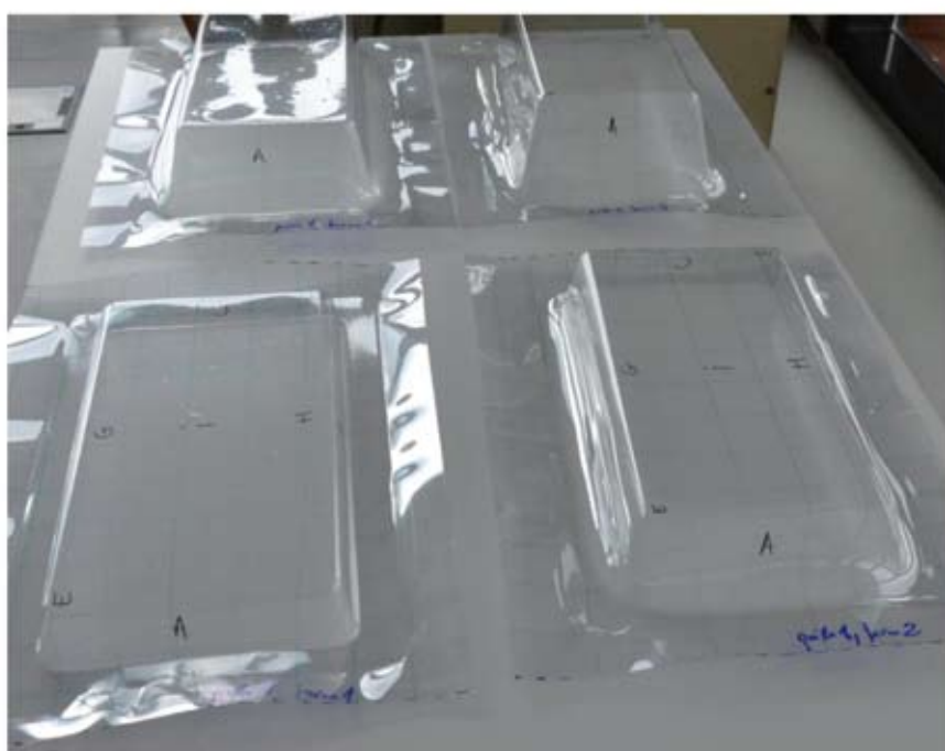
Rys. 5. Kształtki z folii PVC wytworzone przy zastosowaniu form I-IV, przykład Fig. 5. Moldings from PVC foil obtained with the use of the molds I-IV, example
