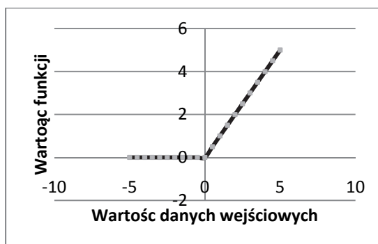
Rys. 1. Kształt funkcji aktywacji \max(0,u)
