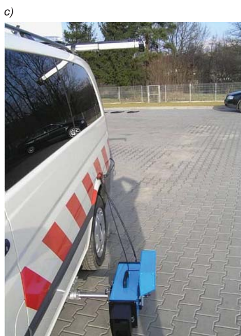
Fot. 3. Elementy systemu pomiarowego urządzenia do mobilnego pomiaru oznakowania poziomego jezdni: a) widok okna programu polowego; b) reflektometr mobilny wraz czujnikiem laserowym do pomiaru tekstury oznakowania; c) stanowisko operatora; d) wyświetlacz ekranowy zewnętrznej bocznej kamery umieszczony w kabinie pojazdu
