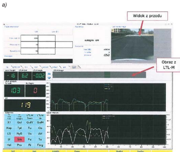
Fot. 2. Urządzenie do pomiaru mobilnego poziomego oznakowania jezdni
