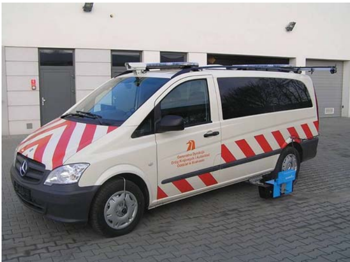
Fot. 2. Urządzenie do pomiaru mobilnego poziomego oznakowania jezdni
