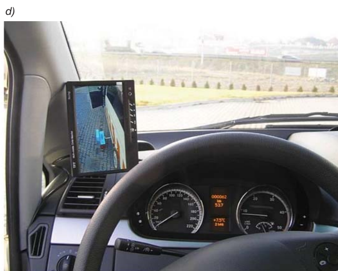
Fot. 3. Elementy systemu pomiarowego urządzenia do mobilnego pomiaru oznakowania poziomego jezdni: a) widok okna programu polowego; b) reflektometr mobilny wraz czujnikiem laserowym do pomiaru tekstury oznakowania; c) stanowisko operatora; d) wyświetlacz ekranowy zewnętrznej bocznej kamery umieszczony w kabinie pojazdu
