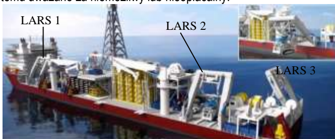
Rys. 1. Schemat jednostki pływającej z trzema systemami LARS do obsługi maszyn górniczych (schemat poglądowy)
