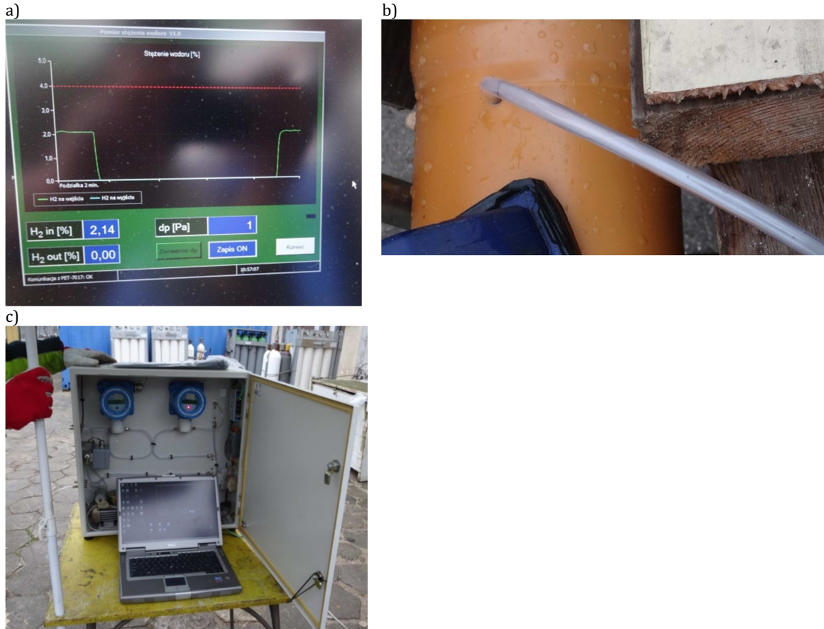
Rys. 10. Badania mieszania wodoru z powietrzem: a) zobrazowanie wyników pomiarów; b) sposób pobierania próbek; c) widok stanowiska pomiarowego.
