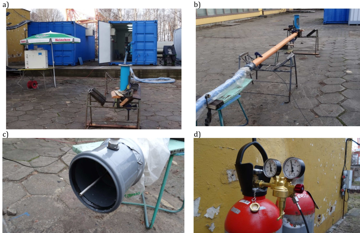
Rys. 9. Reaktor rurowy do wytwarzania mieszaniny wodorowo-powietrznej: a)widok na stanowisko pompy tłoczącej powietrze umieszczonej w kontenerze, z przodu widoczne stanowisko pomiarów rotametrycznych, z lewej stanowisko pomiaru zawartości wodoru w powietrzu; b)widok na mieszalnik rurowy, bliżej na wlocie reaktora widać podłączenie węża tłoczącego do głowicy dozującej reaktora rurowego; c)widok podłączenia linii wodorowej i rurki dozującej wodór do reaktora rurowego, wewnątrz niewidoczna zabudowa dyszy dozującej; d)reduktor ciśnienia na linii wodorowej.
