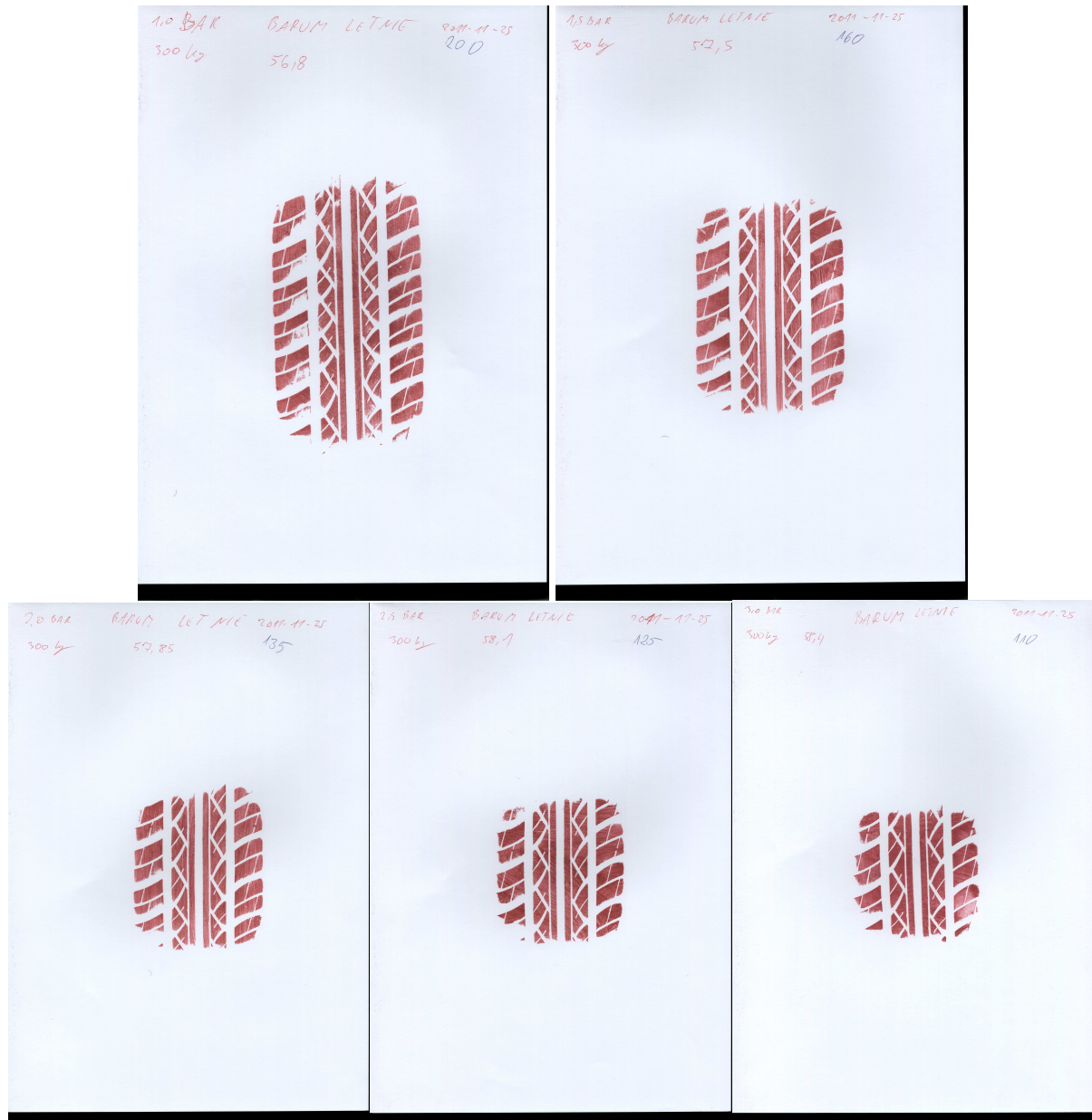
Rys. 3. Widok przykładowych obszarów kontaktu opony z nawierzchnią dla ciśnień od 0,1 do 0,3 MPa i obciążenia promieniowego 300 kg
