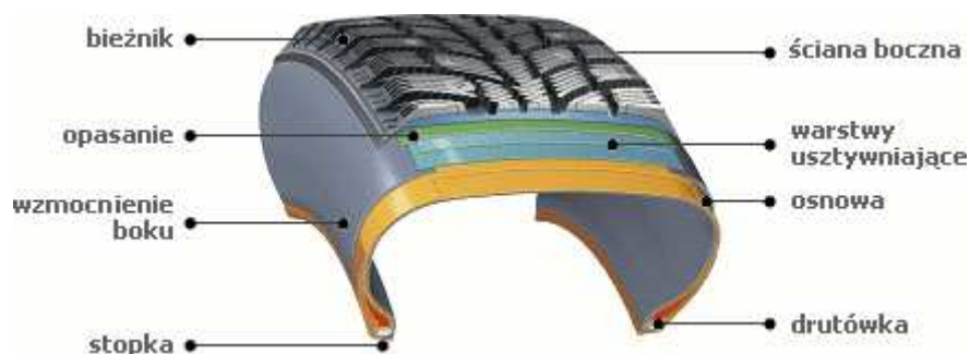
Rys. 1. Ogólna budowa opony pneumatycznej – [www.felgi-opony.com]
