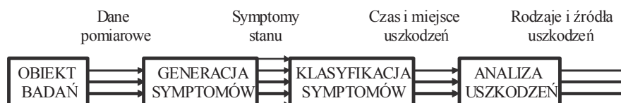
Rys. 5. Schemat zadań układu diagnostyki dla sztucznej inteligencji Fig. 5. Diagram of diagnostic tasks for artificial intelligence
