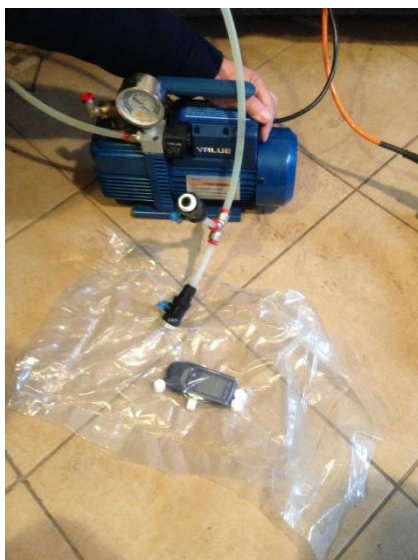
Rys. 2. Procedura odsysania gazów z komory foliowej
