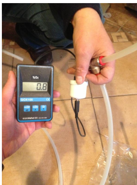
Rys. 3. Test stężenia tlenu w komorze foliowej
