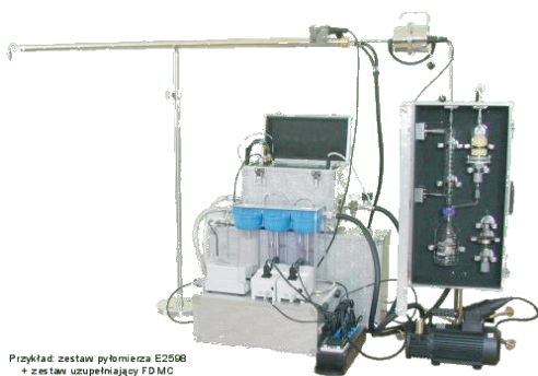
Rys. 2. Schemat zestawu do poboru dioksyn i furanów oraz innych związków organicznych
