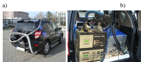
Rys. 14. Pojazd spełniający normę Euro 4 – obiekt badań służący do weryfikacji modeli parametrów cząstek stałych emitowanych z pojazdów osobowych (a) wraz z zamontowaną aparaturą badawczą (b)
