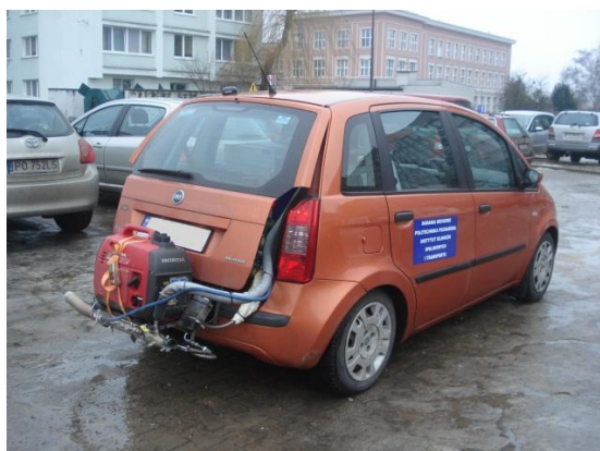
Rys. 3. Pojazd z zamontowaną aparaturą do pomiaru związków toksycznych i parametrów cząstek stałych
