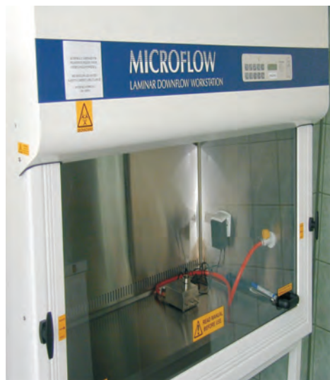
Fot. 2, 3. Komora z laminarnym przepływem sterylnego powietrza do badań mikrobiologicznych oraz hodowle bakteryjne w podłożu płynnym
