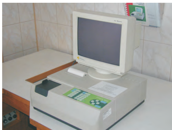
Fot. 4. Spektrofotometr MARCEL MEDIA EKO, stosowany do badań stopnia biodegradacji polimerów
