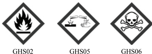
Rys. 1. Kody hasła ostrzegawczego „Niebezpieczeństwo”. Piktogramy określone w rozporządzeniu WE nr 1272/2008 mają czarny symbol na białym tle z czerwonym obramowaniem
