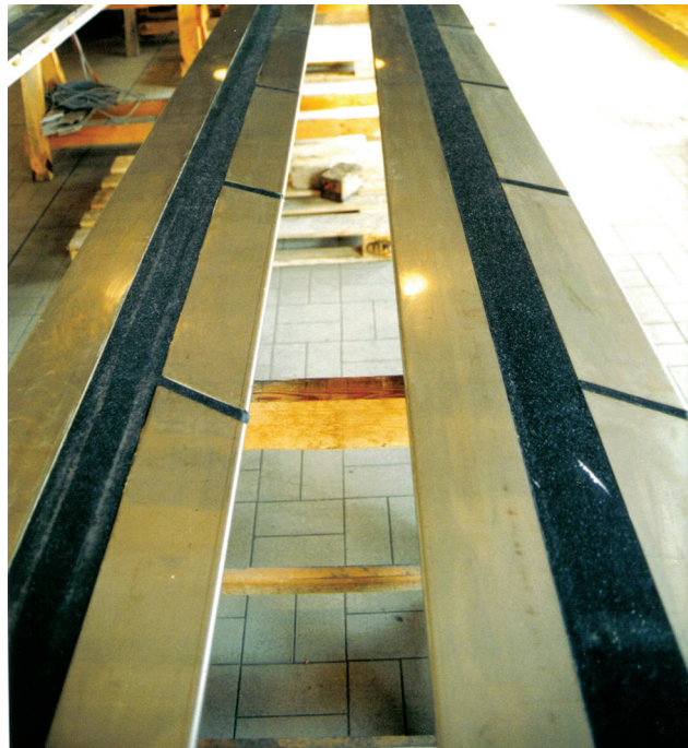
Rys. 3. Szyny zasilające systemu STREAM w laboratorium: lewa ciągła przyłączona do „-”, prawa sekcjonowana przyłączona do „+”, pod napięciem znajdują się tylko 3 sekcje pod przejeżdżającym autobusem
